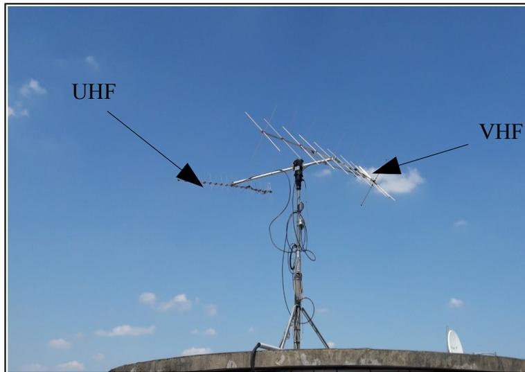
**Figure II.3 :** Antennes croisées VHF/UHF de la station sol CurieSat
