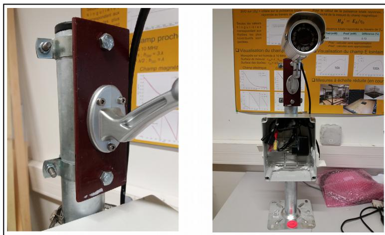
**Figure II.13 :** Installation de la caméra IP sur un mât d'antenne
